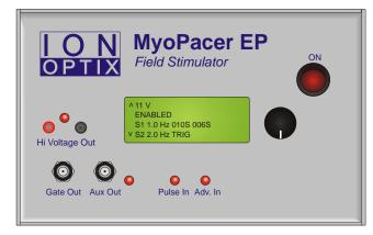
Pulse In: Synchronize pulses to an External TTL pulse train
